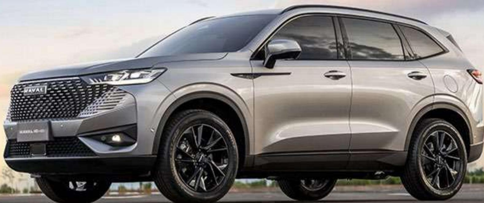
**Híbrido não recarregável em tomadas externas, o Haval H6 HEV tem um motor 1.5 turbo ligado a um elétrico, ambos dianteiros, com um total de 243 cavalos de potência**
