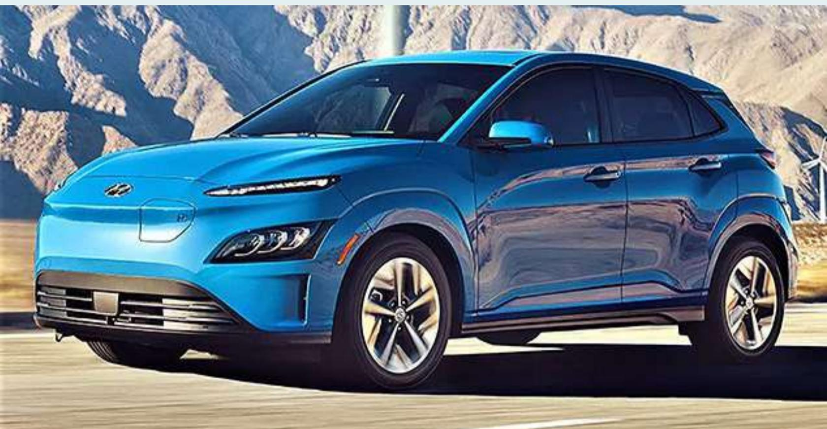
brasileiro. O carro tem motor 1.6 GDI em conjunto a um elétrico, produzindo 141 cavalos de potência combinada (105 cavalos do propulsor a combustão e 43,5 cavalos do elétrico) e 27 kgfm de torque total. A transmissão é de dupla embreagem com 6 marchas. Já o Kona EV, totalmente elétrico, tem 136 cavalos de potência e torque de 40,3 kgfm, acoplado a baterias com capacidade de 39,2 kWh, que garantem autonomia de 252 quilômetros conforme o Inmetro.
